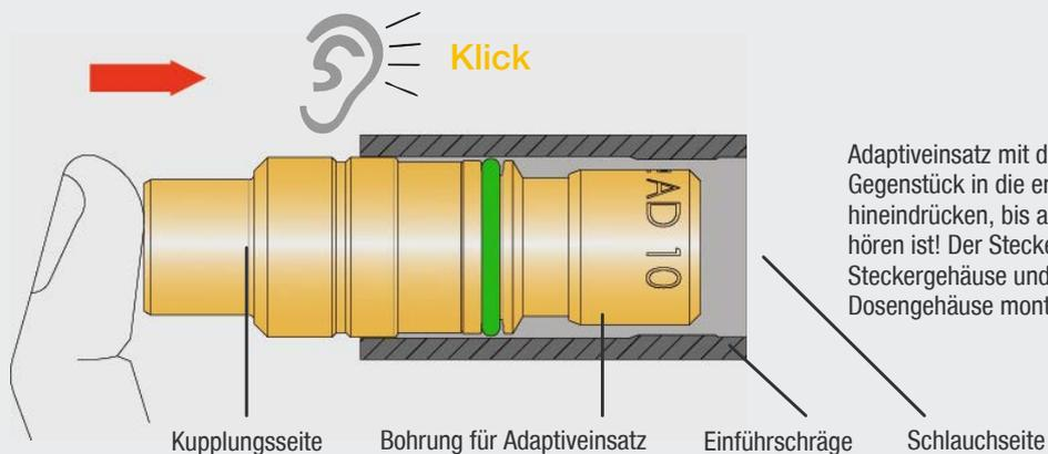
Adaptiveinsatz mit dem Daumen oder mit dem Gegenstück in die entsprechende Bohrung hineindrücken, bis am Anschlag ein Klick zu hören ist! Der Steckereinsatz muss in das Steckergehäuse und der Doseneinsatz in das Dosengehäuse montiert werden.
