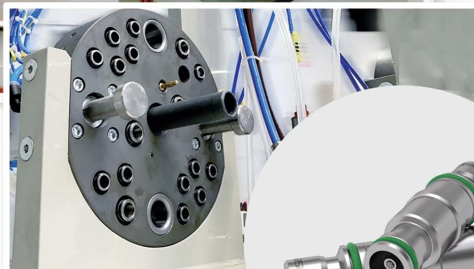
Lackieranwendungen erfordern robuste, nicht verschmutzungsanfällige und leicht handhabbare Anschlüsse. Die Firma **Oerter GmbH & Co. KG** suchte eine Multikupplung, die aus Korrosionsschutzgründen komplett aus Edelstahl besteht, gleichzeitig Leitungen für Druckluft sowie für Lacke und Lösemittel verbindet und lösemittelbeständige Dichtungen aus FFKM beinhaltet. Die Adaptiveinsätze erfüllten alle Bedingungen für die Lackierautomaten.
