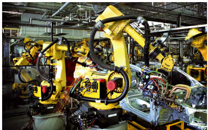
Roboterarme mit stark bewegten Schweißzangen
